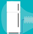
**Installez un récupérateur de chaleur sur les condenseurs.** La chaleur dégagée par les condenseurs lors de la production de froid par les groupes frigorigènes peut être utilisée pour chauffer l'eau par exemple.
