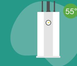
Réglez la température du chauffe-eau à 55°C pour diminuer le temps de préchauffe et limiter la formation de tartre.
